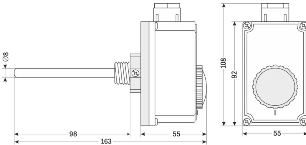
Прибор предназначен для регулировки температуры труб систем радиаторного отопления, теплого пола, горячего водоснабжения и др.
